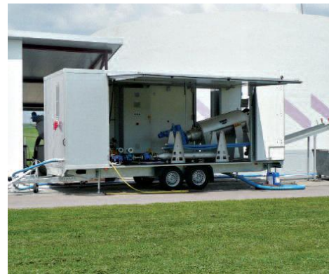
Prensa de sem-fim móvel em reboque
