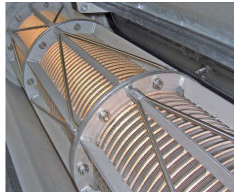
Unidade de filtração robusta em aço inox
