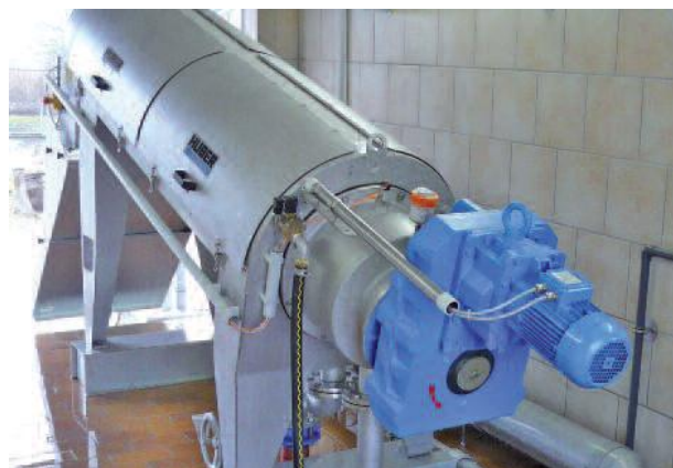
Prensa de sem-fim para uma operação de 24 horas sem supervisão
