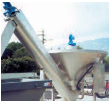
Técnica inovadora: estação COANDA tipo RoSF 4 / BG III, com aquecimento para a operação no exterior
