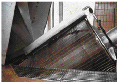
Tamisador de grelha rotativa instalado directamente no canal, fabricado em aço inox e com cobertura
