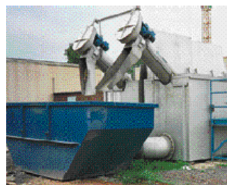
Versão em contentor, instalação de duas linhas, à prova de gelo e com aquecimento
