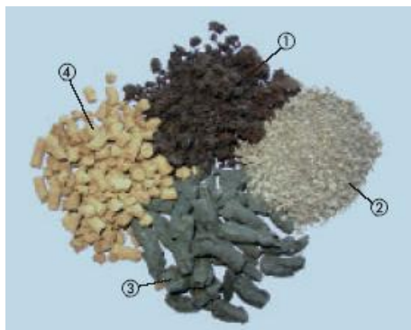
a Lama estabilizada aerobicamente aplicada com um misturador; b Mistura de lama industrial e urbana; c Lamas digeridas extrusadas; d Lama de ETA extrusada
