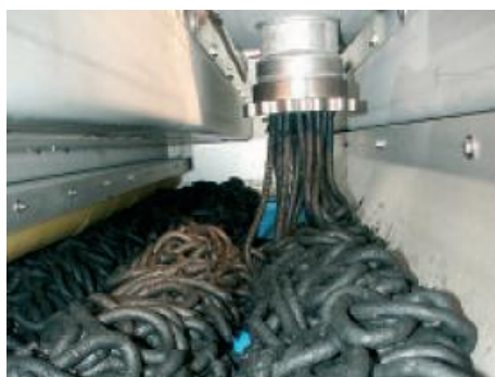
A colocação de lama sobre o extrusor é decisivo para a excelente capacidade do nosso secador de bandas
