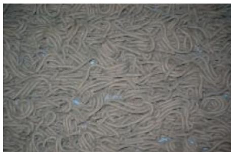
A camada de lama porosa é movimentada lenta e cuidadosamente através do secador; a resistência mecânica e a formação de poeira são mínimos
